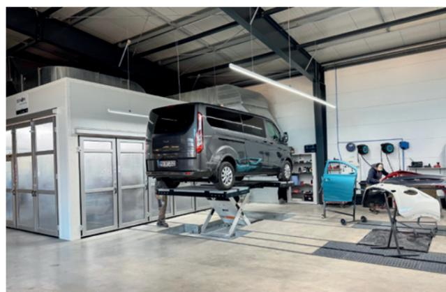
Auch Powerlift-Hebebühnen mit bodenebenem Einbau wurden geliefert
