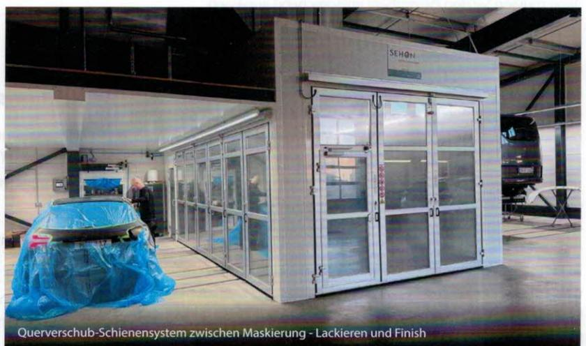
Querverschub-Schienensystem zwischen Maskierung - Lackieren und Finish
