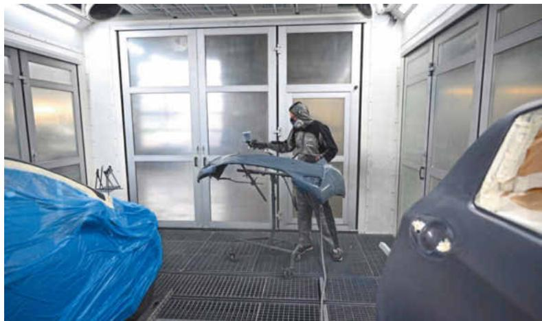
Gamechanger Lackmaterialien: Fabricar setzt auf lufttrocknende Klarlacke, sodass nur selten Kabinentemperaturen über 21 °C benötigt werden. (Foto: M. Rehm)
