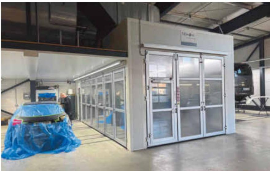
Das Herzstück der Lackieranlage: Von der Vorbereitungsstation geht es per Querverschub durch die Kombikabine bis in den großzügigen Finishbereich. (Foto: Sehon Innovative Lackieranlagen)
